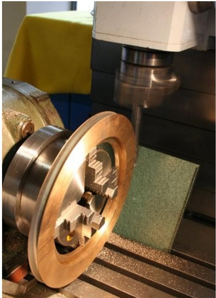
Ora viene montato sulla macchina l' utensile creatore preposto al taglio della dentatura. e vengono montati gli opportuni rotismi che, insieme alla parte elettronica, permetteranno di eseguire il numero voluto di denti.
