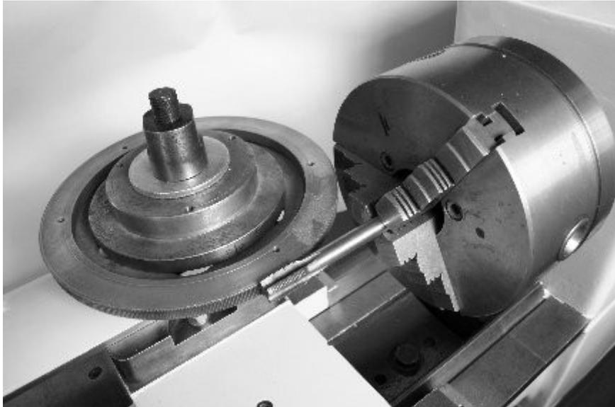
Costruzione di una corona dentata sul tornio mediante maschio per filettare.
