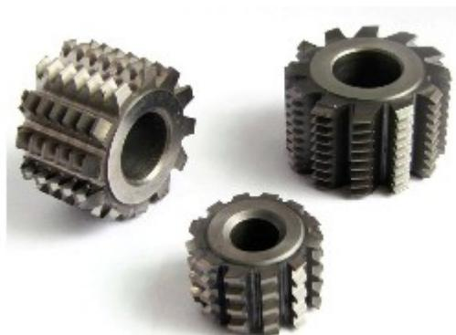
Un sistema elettronico sincronizza il moto del mandrino (e quindi del creatore) a quello della corona in costruzione permettendo una grande precisione nel taglio dei denti della corona.
